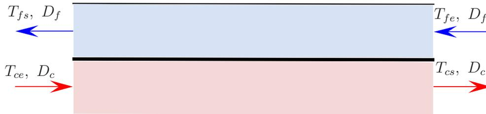
FIGURE 4.4 – Echangeur thermique à contre-courant
