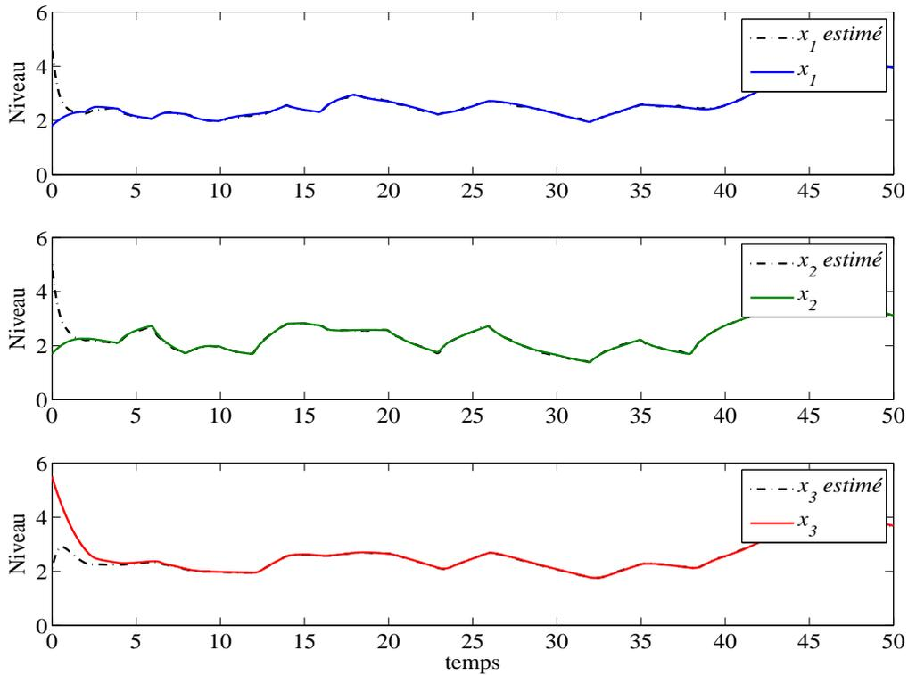
Figure 2.5 – Estimation d'état du système de trois cuves
