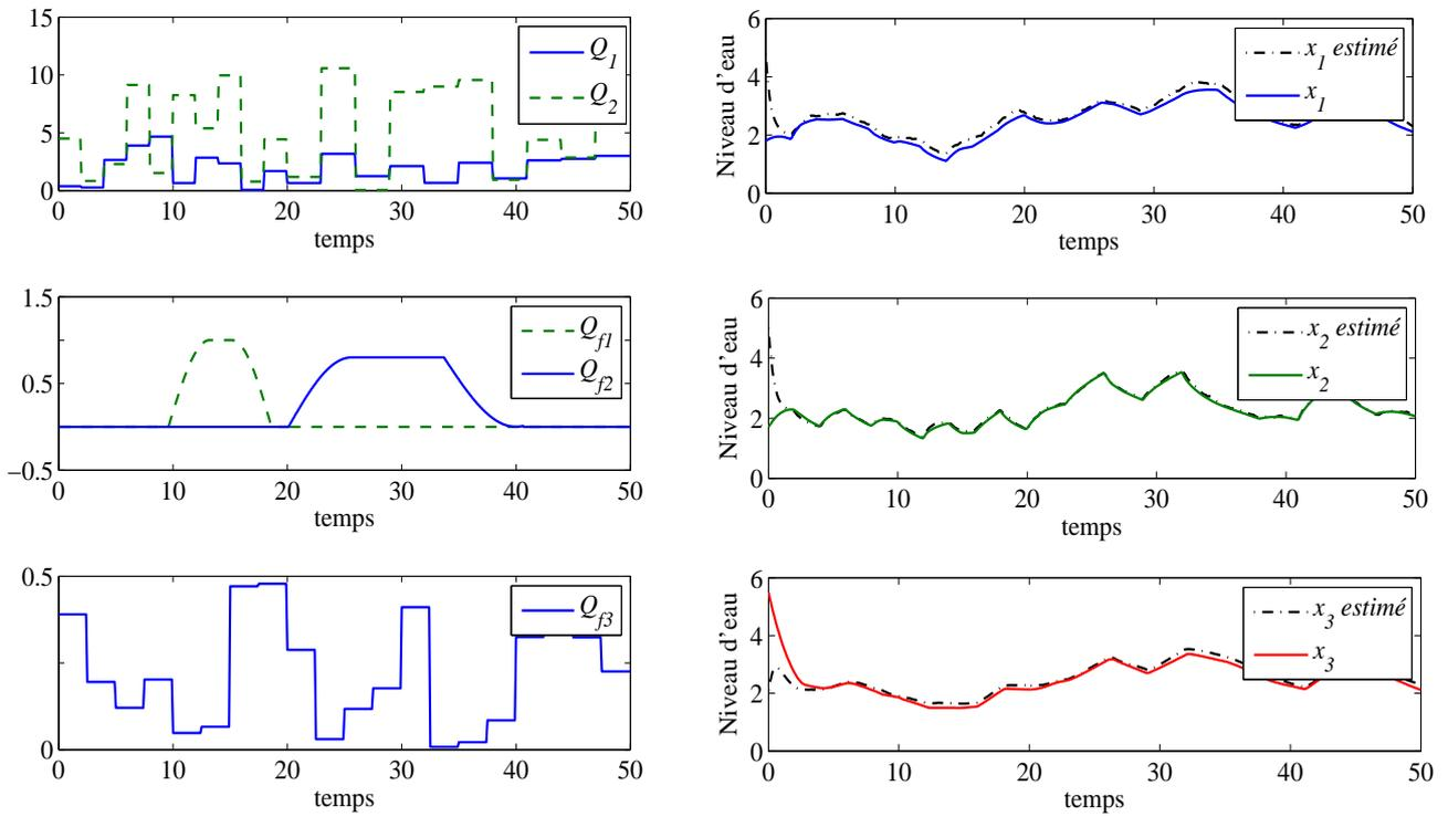
Figure 4.4 – Estimation des états du système de trois cuves
