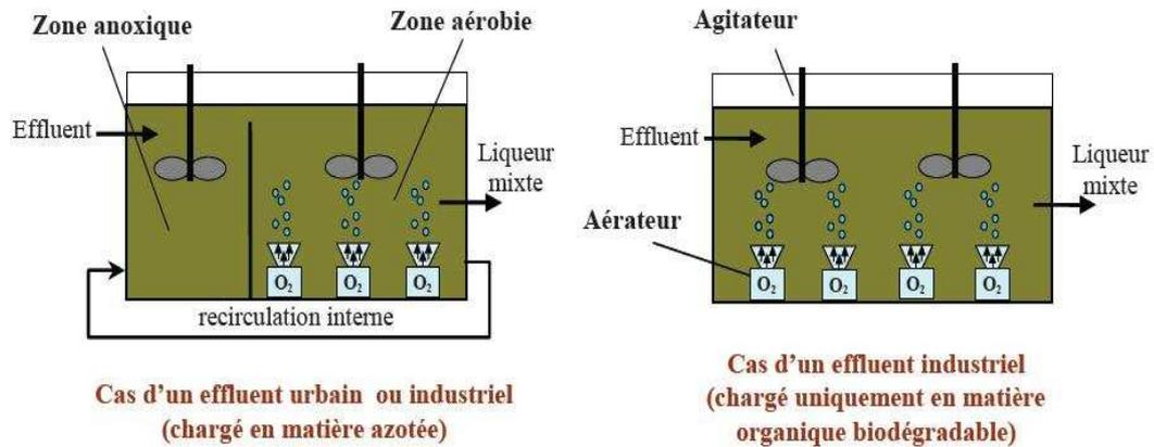
Figure 5.2 – Schéma du bioréacteur dans le cadre de processus d'épuration par boues activées
