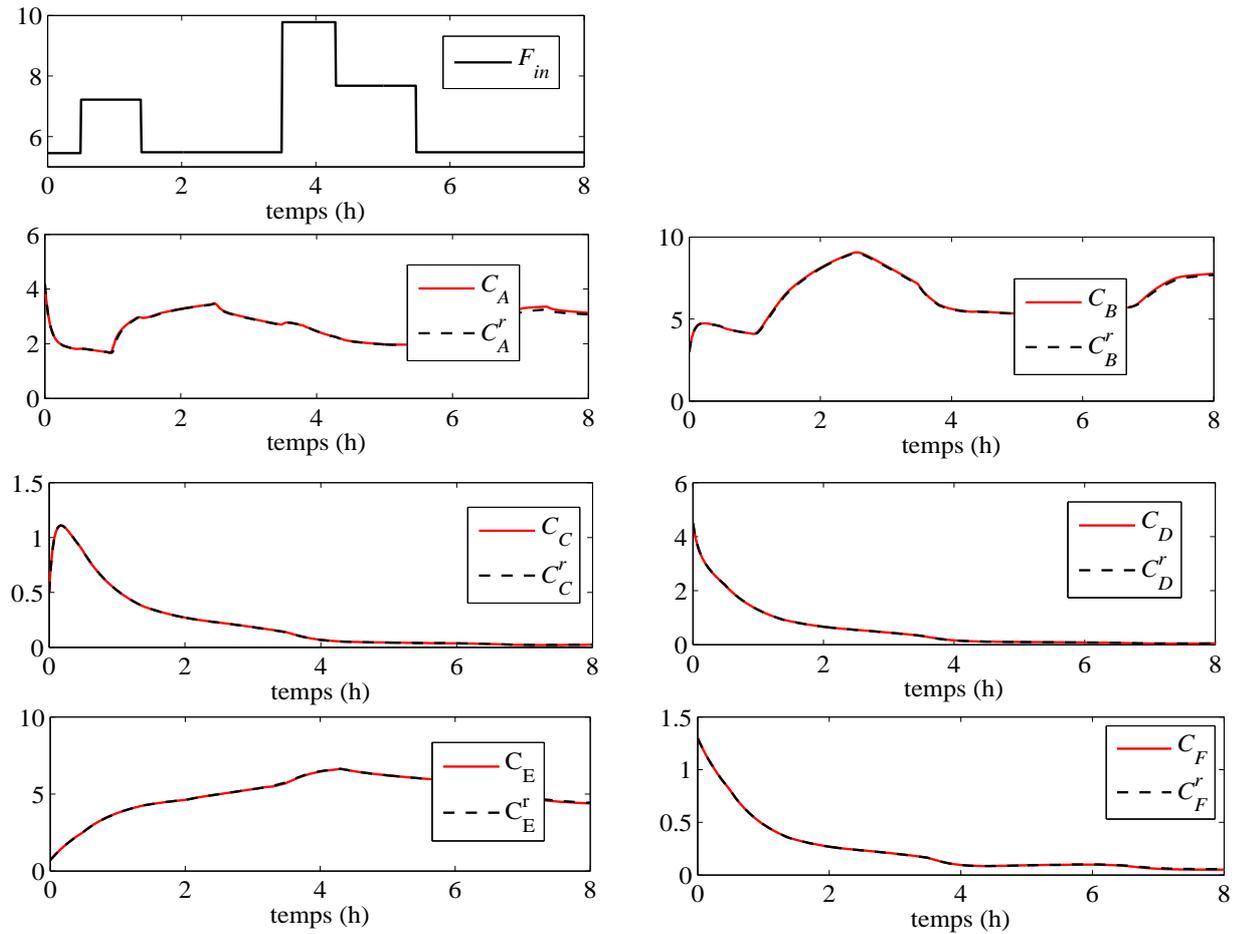
Figure 3.1 – Comparaison entre les états du modèle initial et les états obtenus à partir du modèle réduit par la transformation inverse
