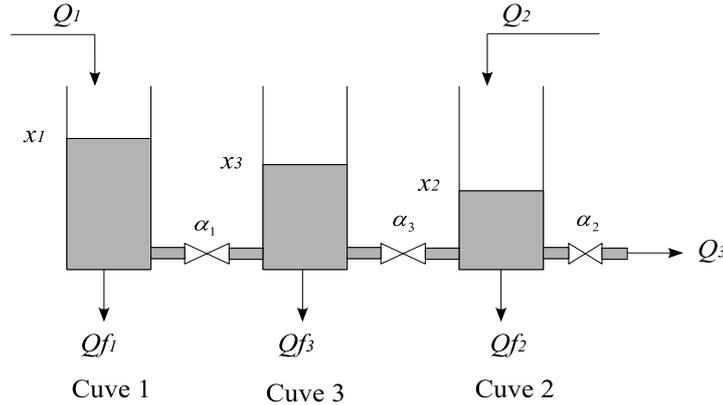
Figure 2.4 – Le système de trois cuves
