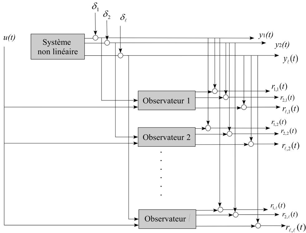
Figure 5.9 – Banc d'observateurs suivant un schéma DOS
