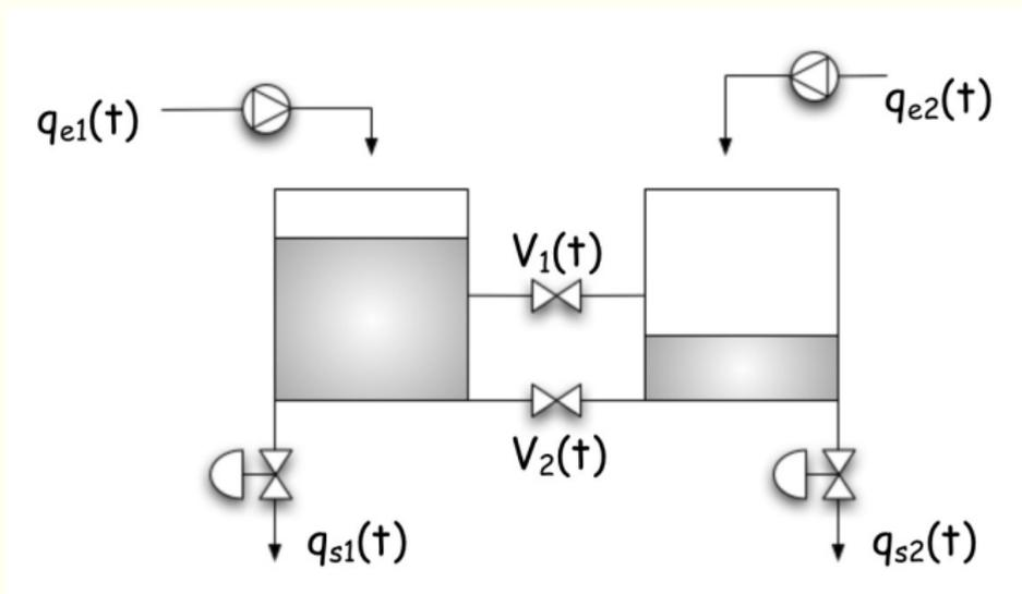
Problème  $P_1$  :  $\{q_{e1}, q_{e2}, q_{s1}, q_{s2}, V_1, V_2\} \rightarrow \{h_1(t), h_2(t)\}$
