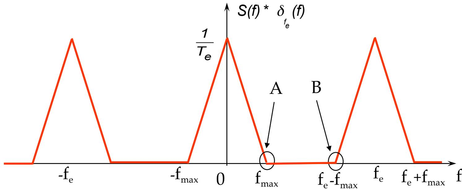
*Pour éviter le repliement spectral, il faut  $B > A$ :*
