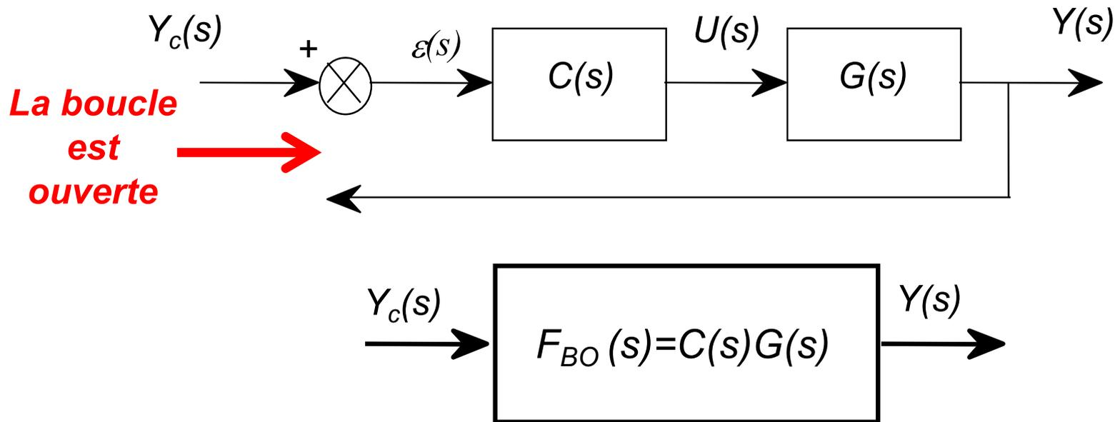
*Une commande en boucle ouverte est rarement utilisée en pratique*
