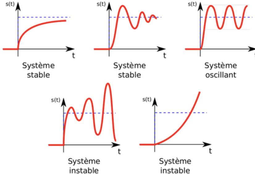
Un système est stable si sa réponse indicielle (à un échelon) tend vers une valeur finie lorsque  $t \rightarrow +\infty$ .
