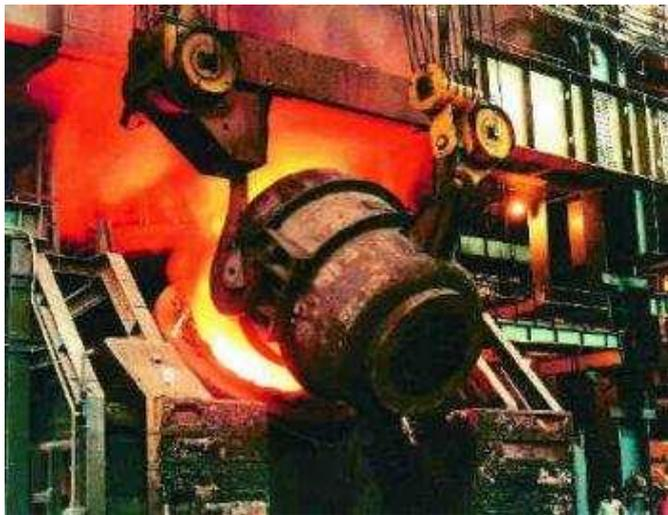
FIG. 1 – Chargement d'un convertisseur à oxygène
