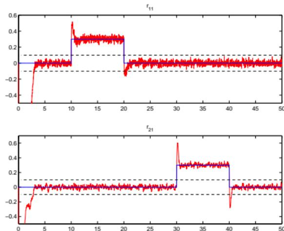
FIG.: Résidus en présence des défauts capteurs  $f_1$  et  $f_2$
