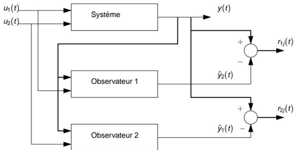
FIG.: Schéma de détection et localisation de défauts d'actionneurs
