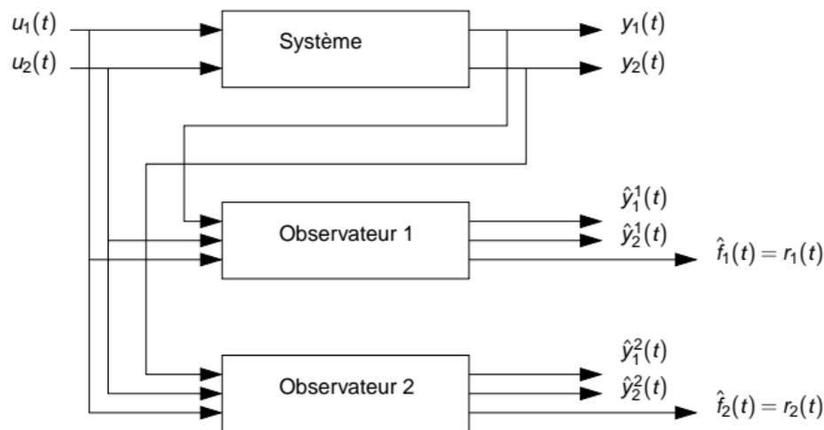
FIG.: Schéma de détection et localisation de défauts de capteurs
