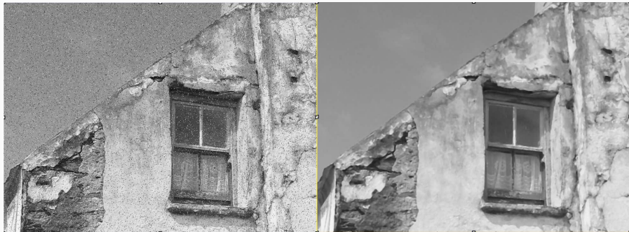
Figure 2: Image bruitée (poivre et sel) – image filtrée (filtre médian)
